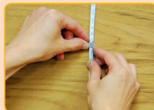
เข้าเข็มขัดรัดสายไฟฟ้า
