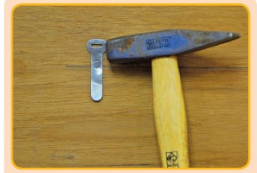
แต่งเข็มขัดรัดสายไฟฟ้าให้ตรง
